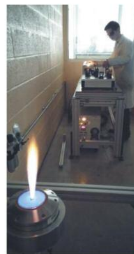
Mesure de la concentration des suies dans une flamme par LII
