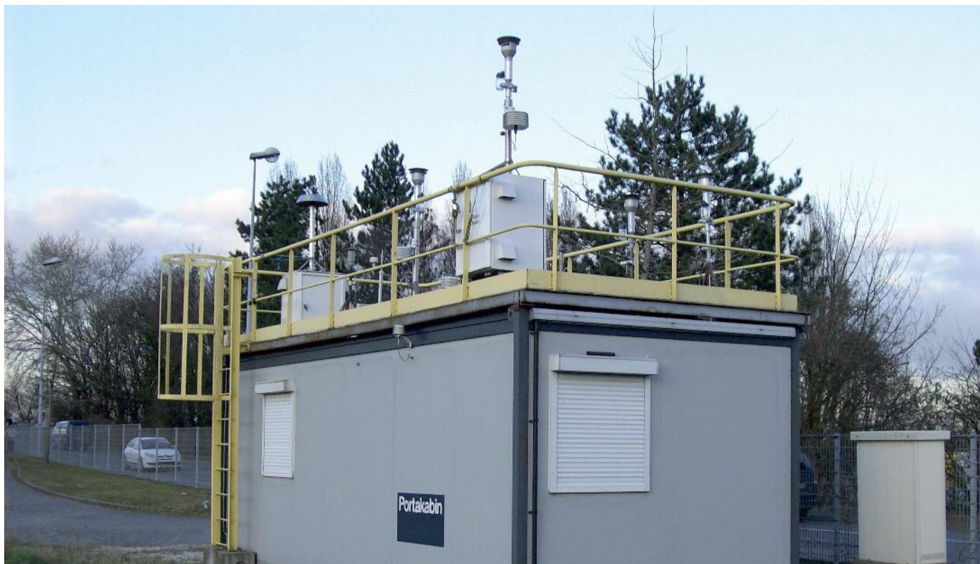
plateforme de tests et d'essais pour la mesure des fines particules atmosphériques
